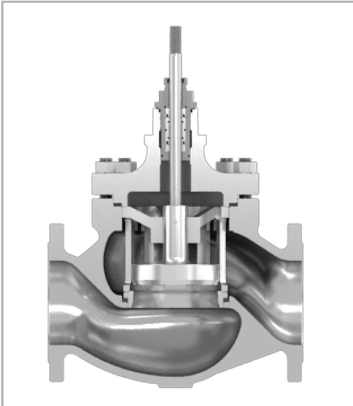
◆ L20400系列分别采用阀心圆弧式密封设计与自中心定位泄压式阀心设计, 有效保证了其密封结合面的严密配合, 确保达到ANSI Class VI泄漏等级。单阀座圆弧式密封面, 可采用了流开与流关两种流向, 配置不同推力的执行器, 可大大提高关闭压差范围。针对高关闭压差, 可选用泄压式双阀座, 泄压式双阀座采用流关式设计, 开启小阀心可消除部份不平衡力。两种不同内件的选择, 使不平衡式切断型控制阀的使用范围覆盖包括低温、高温及高压差的不同工况。
