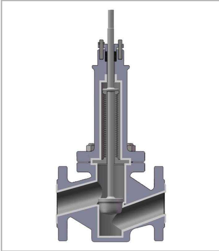
◆ L21241C直行程内衬控制阀，采用阀体与内件全部衬氟结构，有效阻隔了腐蚀介质对阀体中金属材料的腐蚀。金属阀体内腔采用齿式加工处理，使内衬材料与金属接合，增长内衬材料的使用寿命与性能。阀杆密封采用RTFE波纹管密封与V型PTFE填料两种组合密封，消除了介质从阀杆处向外的泄漏。不平衡式全衬氟控制阀特别针对低压常温工况下极具强腐蚀的介质的使用。
